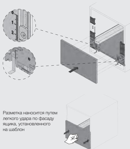
Разметка наносится путем легкого удара по фасаду ящика, установленного на шаблон
