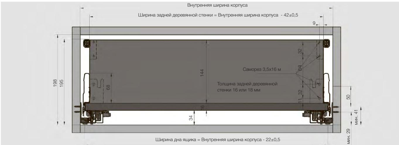
Метод расчета размеров передней панели: Размер передней панели = внутренняя ширина корпуса - 124
